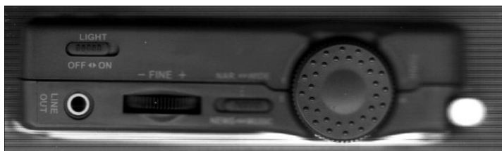
Questo è il fianco destro, con la manopola di sintonia, il comando per il BFO, la presa per il registratore, l'interruttore per l'illuminazione del display frontale, il selettore del filtro.
