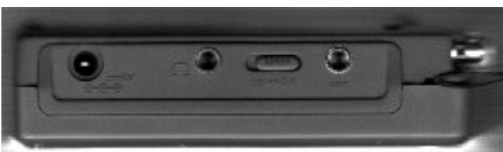
Questo è il fianco sinistro, con la presa per l'alimentazione esterna, la presa per le cuffie, l'attentatore d'antenna a due posizioni, la presa d'antenna esterna. Differenze? Nessuna.
