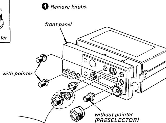
• ATTACHING THE SW BAND SELECTOR KNOBS
