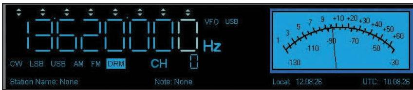
Visualizzazione di frequenza, modo, passo di sintonia, S-meter, ora locale e UTC
