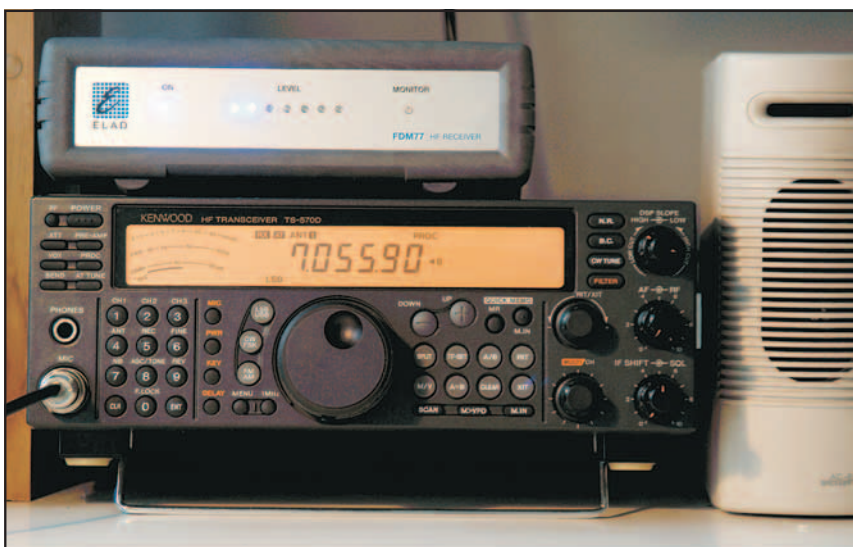
Le proporzioni del ricevitore ELAD FDM77 a confronto con un Kenwood TS-570D: dimensioni 200 x 60 x 190 mm; peso circa 1 kg
