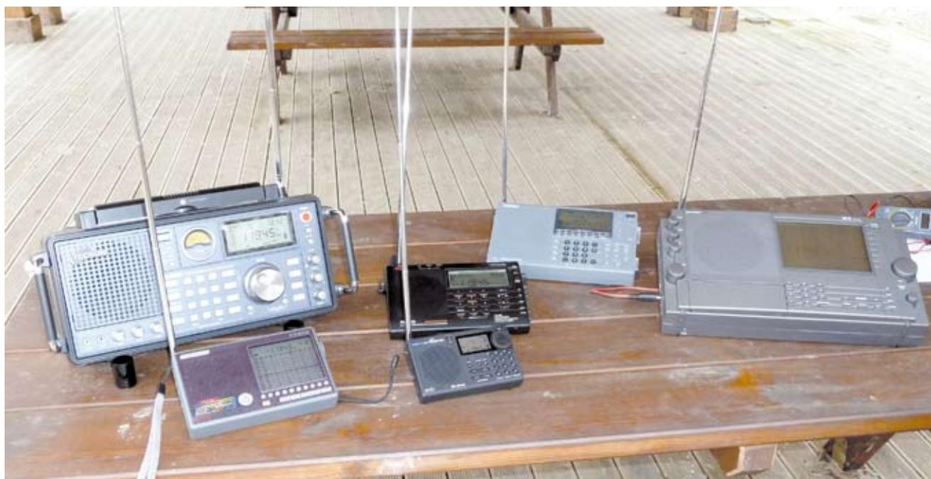
mercato occidentale i prodotti Tecsun con i propri marchi, tra cui, per l'appunto Grundig e Eton (essendo quest'ultima proprietaria del marchio Grundig). Il ricevitore Tecsun S-2000 è l'unico provvisto di uscita a IF a 455 kHz, essendone sprovvisti i due modelli 750 Satellit. I tre ricevitori utilizzano la tecnologia **DSP** ma, mentre Tecsun lo rende di pubblico dominio, Grundig e Eton non lo pubblicizzano (eppure appare evidente sia dalle prestazioni che dallo schema elettrico).
