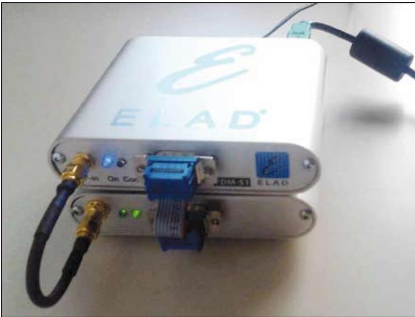
testazione dei connettori, ben avvolti da guaina termorestringente e di tipo dorato, per una perdita di inserzione ridotta al minimo.
