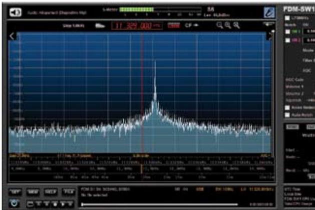
Ricevitore senza filtro antialiasing (LP30MHz) e disconnesso da SFE1. Il segnale a 50,110 MHz ha prodotto quanto si vede nella foto; il picco è a -30 dBm.
