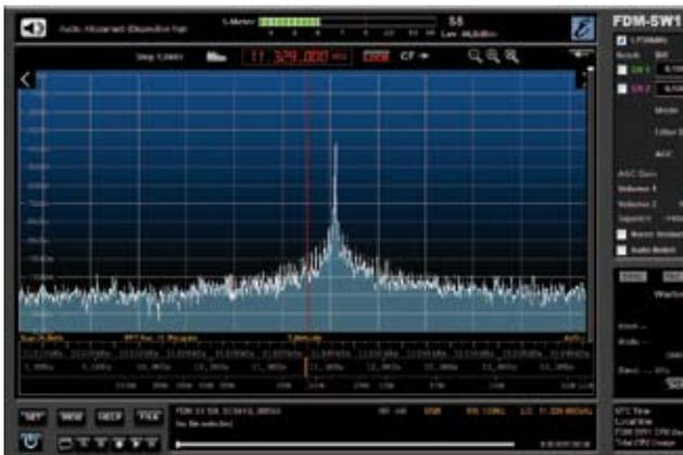
Ricevitore con filtro antialiasing LP30MHz inserito e disconnesso da SFE1. Il filtro mostra un abbattimento della figura di rumore complessiva ed un abbassamento del picco di segnale a circa -40 dBm.
