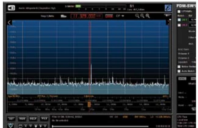
Qui il ricevitore è stato connesso con SFE1, e non è stato inserito il filtro LP30MHz. L'abbattimento del picco di segnale è notevole, come notevolmente ripidi sono i fianchi del filtro.
